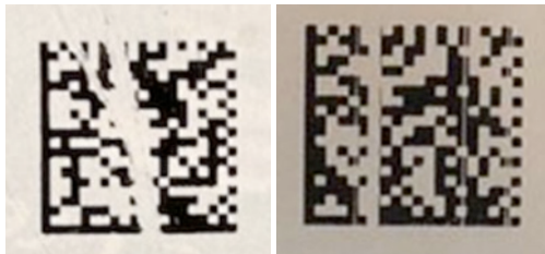
Нарушение целостности КМ*
